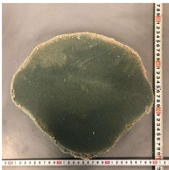
6号硅砂地盤2次元注入実験での改良体の様子
