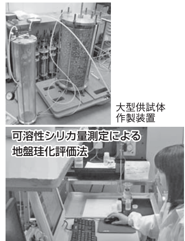
写真6 ICP分析による地盤珪化評価法(強化土エンジニアリング株式会社/日本化学工業株式会社 共同開発)
