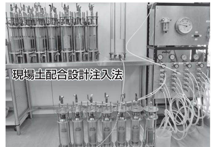
写真5 現場採取土を用いた本設注入試験センターにおける供試体注入試験(本設注入試験センター/強化土研究所内) 撮影:2015年9月
