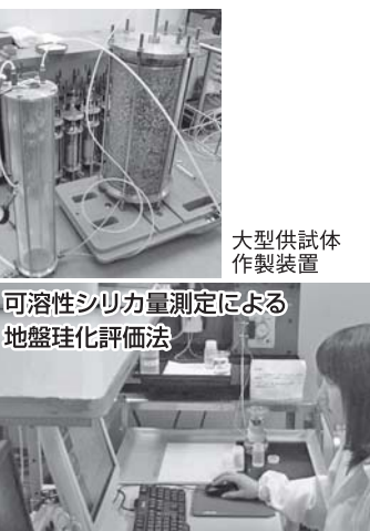
写真6 ICP分析による地盤珪化評価法(強化土エンジニアリング株式会社/共同開発)
