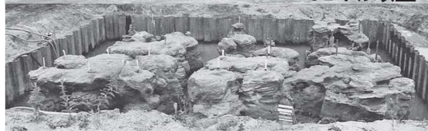
写真1 1999年産学協同研究による大規模野外試験における恒久グラウトを用いた浸透固結性と経年固結性の実証 (株)ADEKA鹿島工場敷地(神栖)
